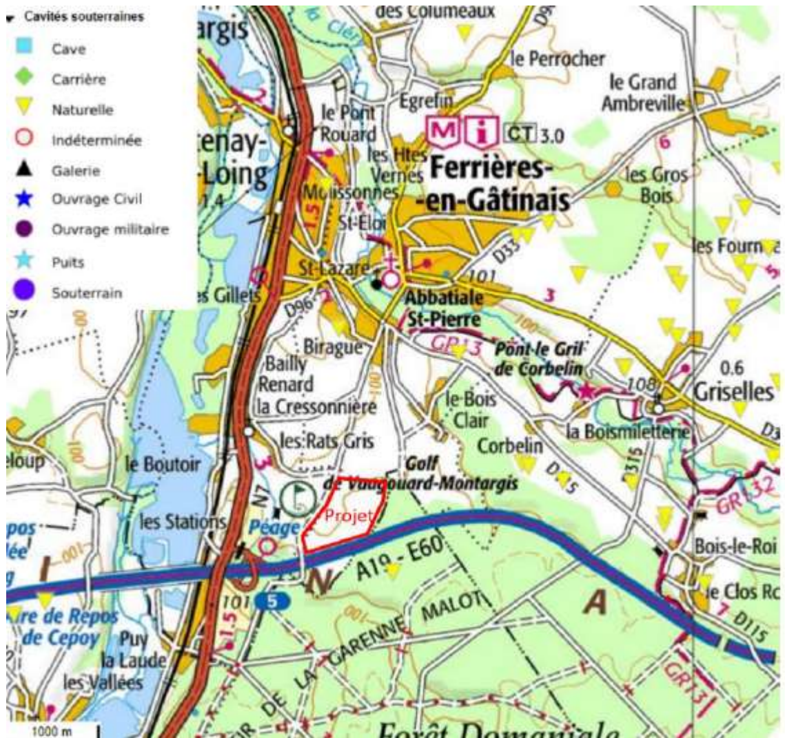
Localisation des cavités (source : Géorisques / BRGM)
