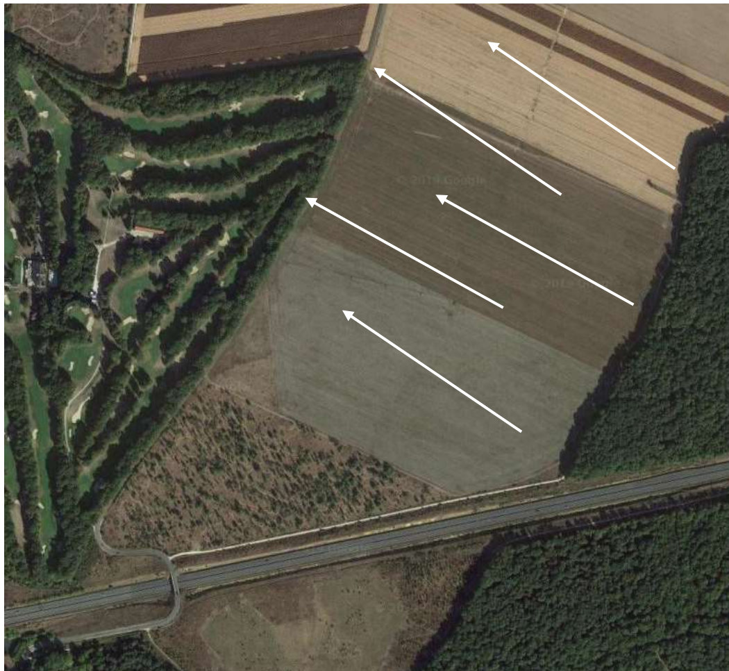
Sens des écoulements sur le terrain
