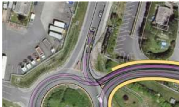
Conditions de giration des poids-lourds en entrée et en sortie de voie nouvelle
